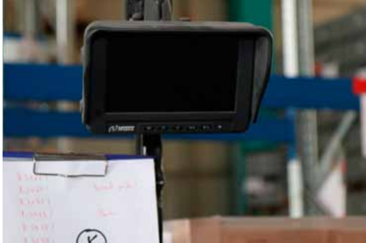
Kleine Maßnahme - große Wirkung: Mit der Kamera an der Gabel und dem Monitor in der Kabine wird das Ein- und Ausfahren auch über die dritte Ebene hinaus zum Kinderspiel.
