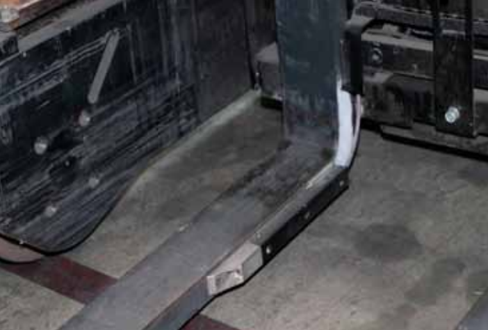
Kleine Maßnahme - große Wirkung: Mit der Kamera an der Gabel und dem Monitor in der Kabine wird das Ein- und Ausfahren auch über die dritte Ebene hinaus zum Kinderspiel.
